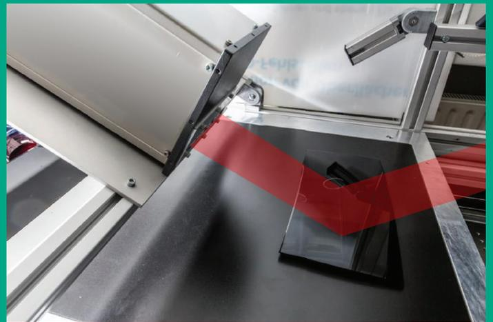
Die besonders schmale Rückstreukeule des Retroreflektors erlaubt eine feine Ortsauflösung. Bei anderen industriellen Inspektionssystemen des IOSB konnten damit Strukturen  $< 100 \mu\text{m}$  detektiert werden. In dieser Anwendung erlaubt die hohe Auflösung die automatische Detektion entsprechend feiner Inhomogenitäten der Beschichtung, der Oberflächenbeschaffenheit oder der Materialzusammensetzung.
