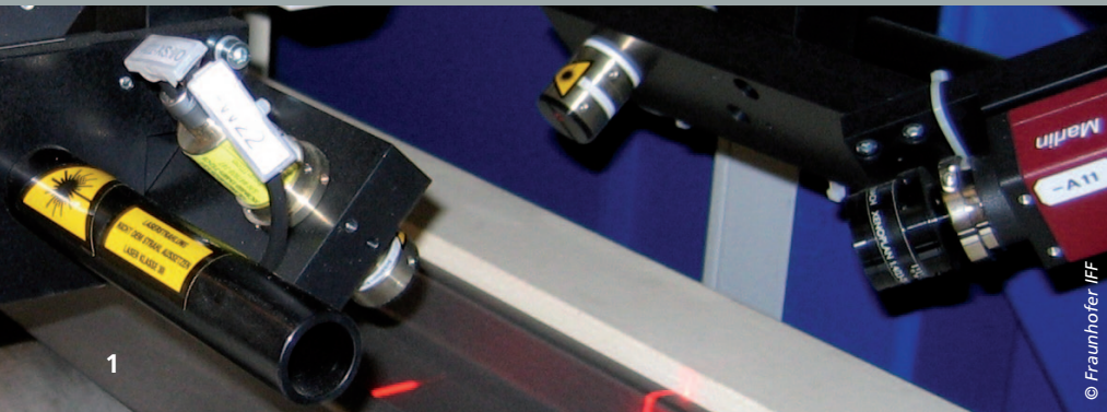
1 - 2 Sensoreinheit zur Geradheitsprüfung.
