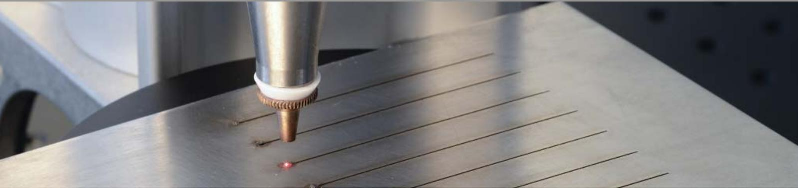
*Integriertes Inline-Messsystem für das adaptive Laserbasierte Schneiden von komplexen Oberflächen*
