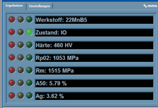
Ergebnisdarstellung der 3MA-Messung eines pressgehärteten Karosserieteils
