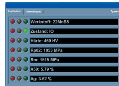
Ergebnis einer 3MA-Prüfung
