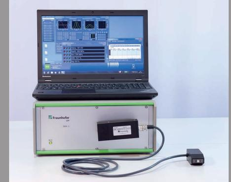
3MA-Prüfsystem mit Sensor
