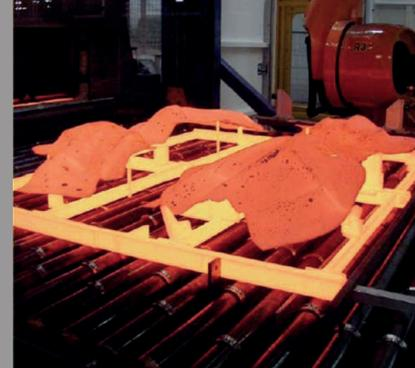
Erwärmung der Platinen im Durchlaufofen
