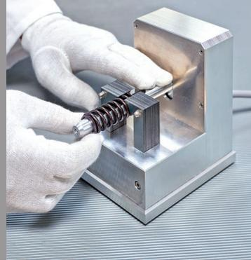
Prüfung von Ventildedern mit vollautomatisiertem (links) und manuellem (rechts) Ventildederscanner
