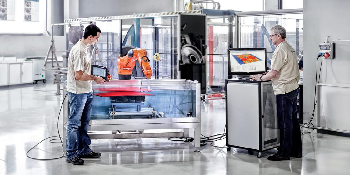
*Das Exponat demonstriert die robotergestützte Ultraschall-Prüfung mit integrierter 3D-Rekonstruktion des Bauteilvolumens. Der Roboterarm tastet das Bauteil ab; die Daten werden während der Aufnahme in Echtzeit verarbeitet und als dreidimensionale Rekonstruktion des Bauteilvolumens ebenfalls in Echtzeit visuell dargestellt.*
